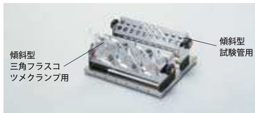
图片是把振荡架设置在锁扣台上的例子
